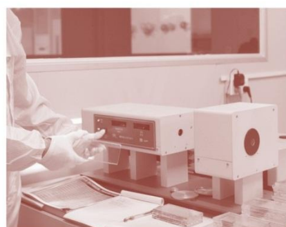
雾度测量仪 Haze Tester 测试胶片雾度 Testing Haze
