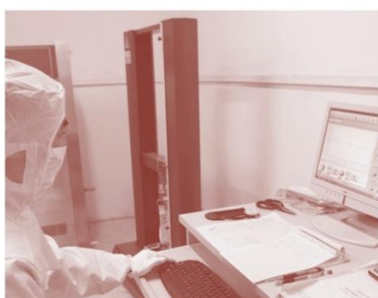
电脑智控万能薄膜拉力机 Universal Testing Maching 测试胶片抗拉强度、剥离强度等 Testing tensile strength, peeling strength
